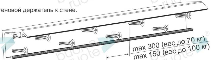
Для крепления трека должны быть использованы все отверстия в профиле.
