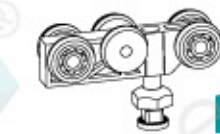
Каретка 6-ти колесная, МЯГКИЙ ХОД, нагрузка 130 кг на пару 56.2510.66/S/V
